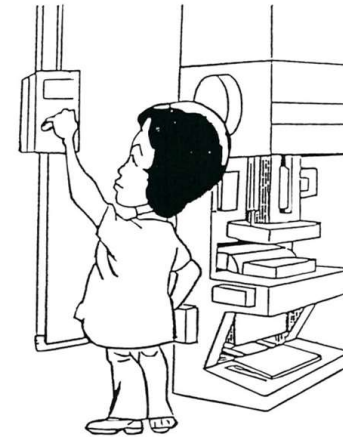
เมื่อปิดเครื่องจักรแล้ว ควรปลดสวิตช์ไฟให้อยู่ด้วย
